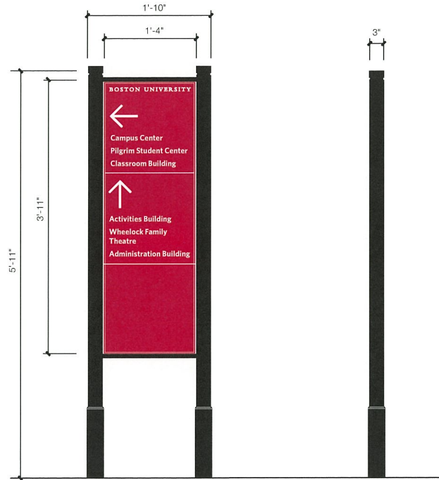
A: Elevation - Side A Shown 3/4" = 1' - 0"
